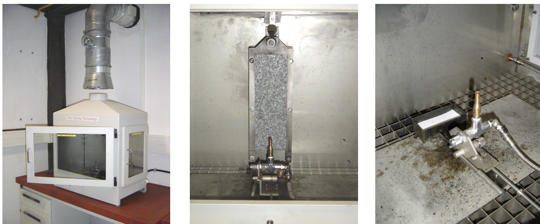
Figuras 3, 4 e 5: Montagem experimental do ensaio de ignitabilidade no LNEC/LERF – câmara de combustão e conduta de extracção de gases; estrutura de fixação da amostra; queimador e recipiente com papel de filtro.
