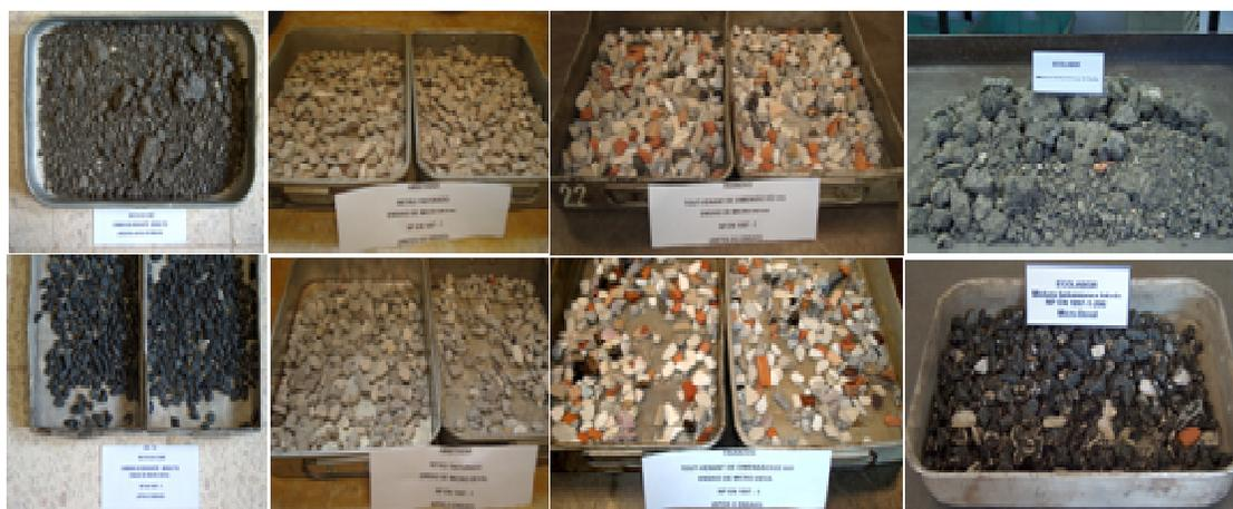
Figura 5 | Aspecto das amostras de agregados reciclados, antes e após o ensaio de micro-Deval
