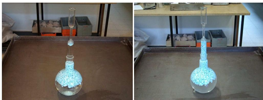
Figura 3 | Determinação das massas volúmicas e absorção de água das amostras RCD-LEVE
