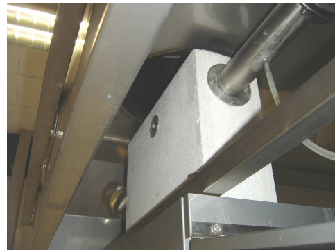
Figuras 6 e 7: Fluxímetro térmico em posição de referência e pormenor da instalação do sistema óptico para medição de fumo na conduta de extracção.
