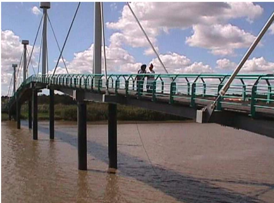
Fig. 49 - Medição de parâmetros com sonda multiparamétrica, a partir duma ponte para peões sobre o rio Sado (notar como a velocidade da corrente arrasta a sonda)
