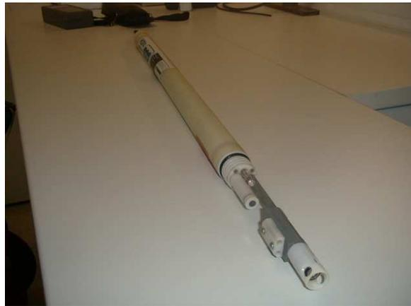
Fig. 37 - Sonda multiparamétrica para monitorização *in situ* de águas subterrâneas
