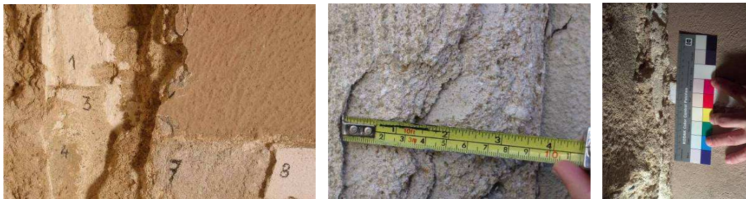
Fig. 2 – Identificação do número de camadas, da espessura, da textura e da cor do revestimento
