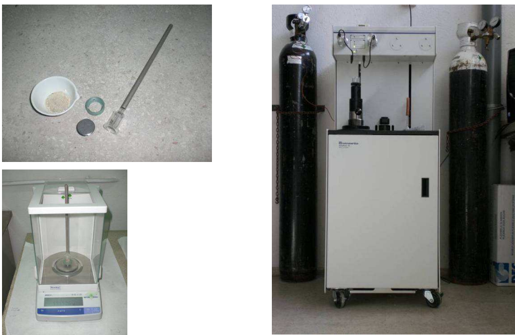
Fig. 20 – Equipamento de porosimetria de mercúrio . Preparação e pesagem da amostra para o ensaio.
