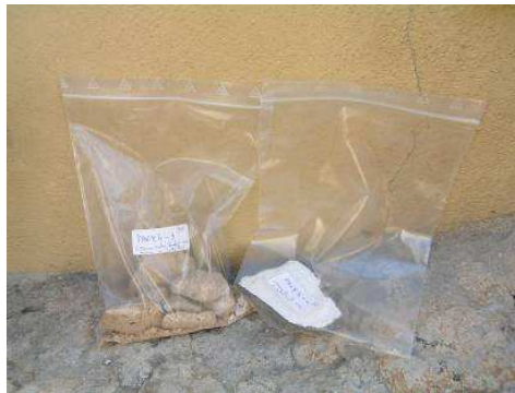
Fig. 16 – Armazenagem de amostras em sacos de plástico devidamente fechados antes da determinação do teor de água pelo método gravimétrico
