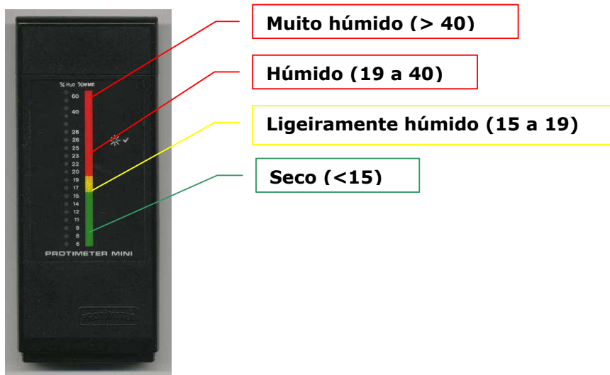
Fig. 8 – Humidímetro portátil. Classificação do grau de humidade em função dos valores de referência do aparelho utilizado
