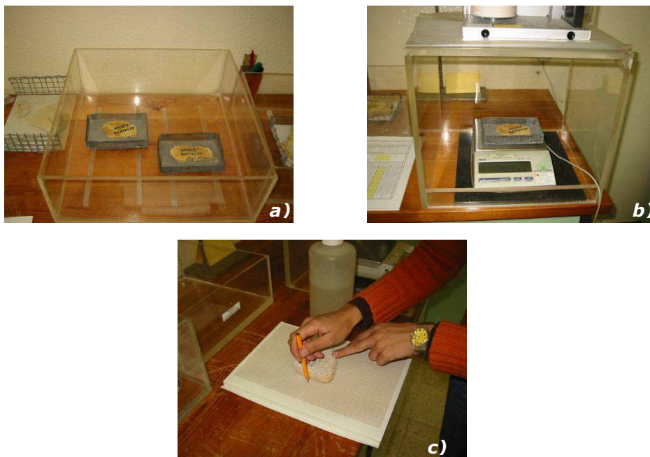
Fig. 19 – Ensaio de absorção de água por capilaridade por contacto:
