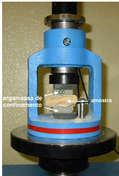
Fig. 18 – Ensaio de resistência à compressão – método do confinamento
