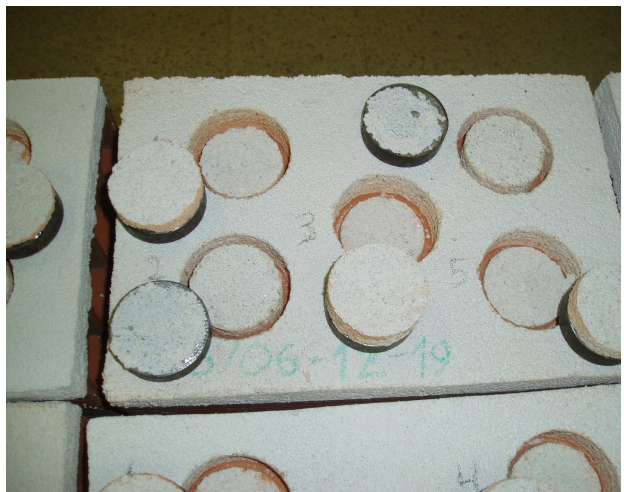
Fig. 14 - Provetes do ensaio de aderência ao suporte, após ensaio.
