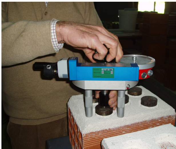
Fig. 13 - Ensaio de aderência ao suporte: arrancamento
