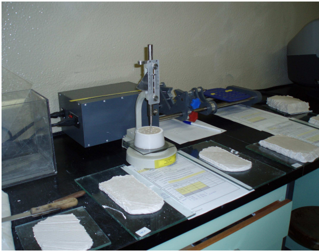
Fig. 11 - Determinação do início de presa (método do cone de Vicat)
