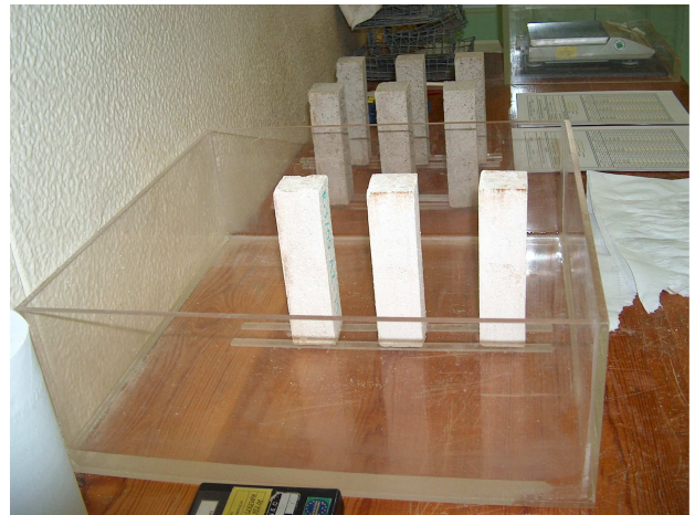
Fig. 16 – Ensaio de absorção de água por capilaridade
