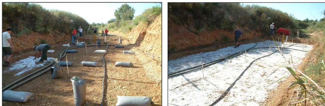
Figura 7 – Colocação do traçador (NaCl) na bacia de infiltração de Carreiros
