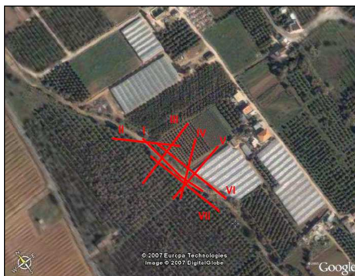
Figura 12 – Localização dos sete perfis de resistividade eléctrica realizados no caso de estudo de Carreiros (Mapa de base retirado do Google Earth) (extraído de Mota, 2007)
