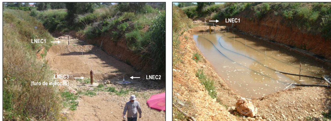
Figura 6 – Pormenor da bacia de infiltração (Sul) de Carreiros, antes e durante a realização do ensaio de infiltração
