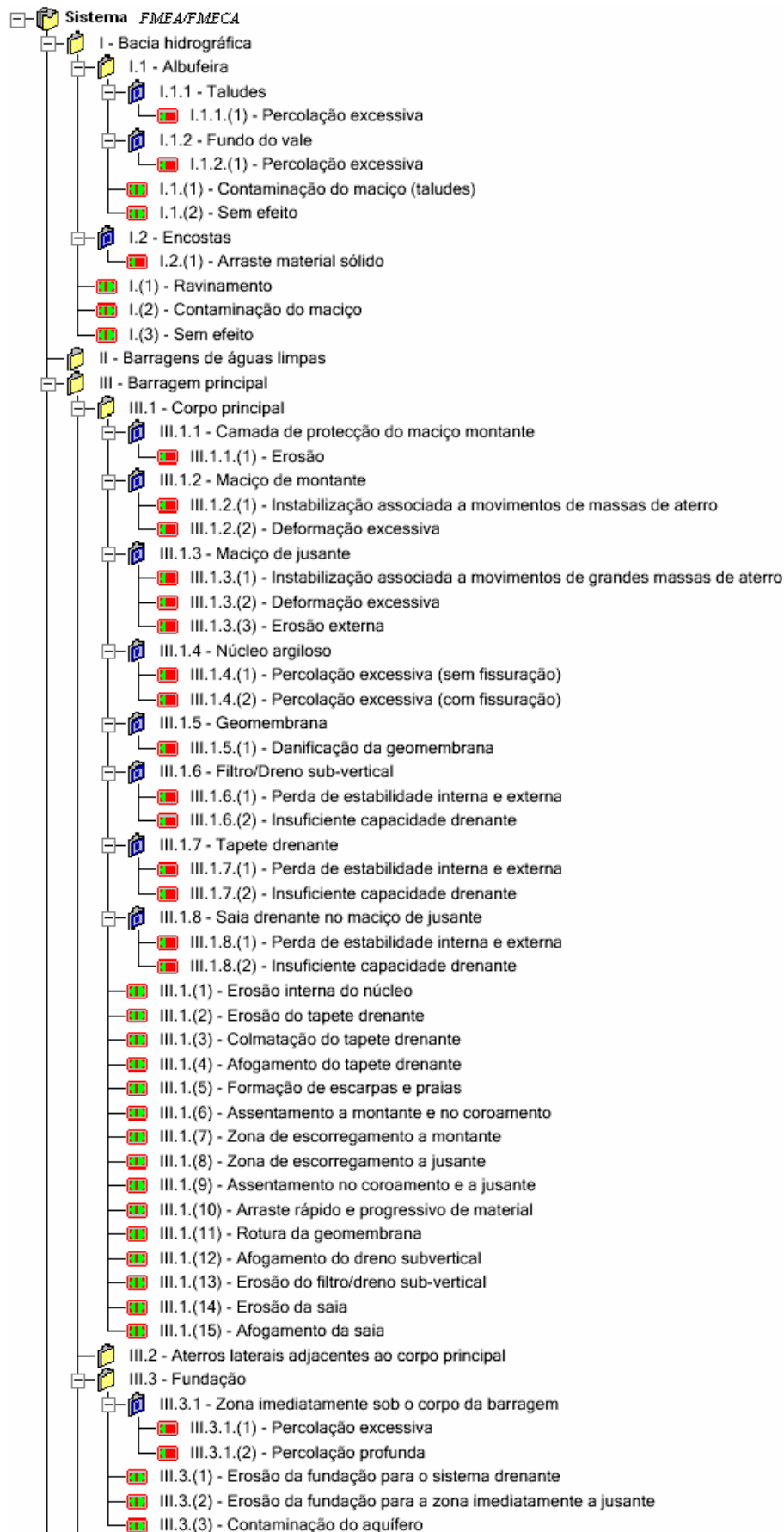
Figura B.1 – Modos potenciais de rotura para todos os subsistemas do sistema correspondente à barragem de Cerro do Lobo
