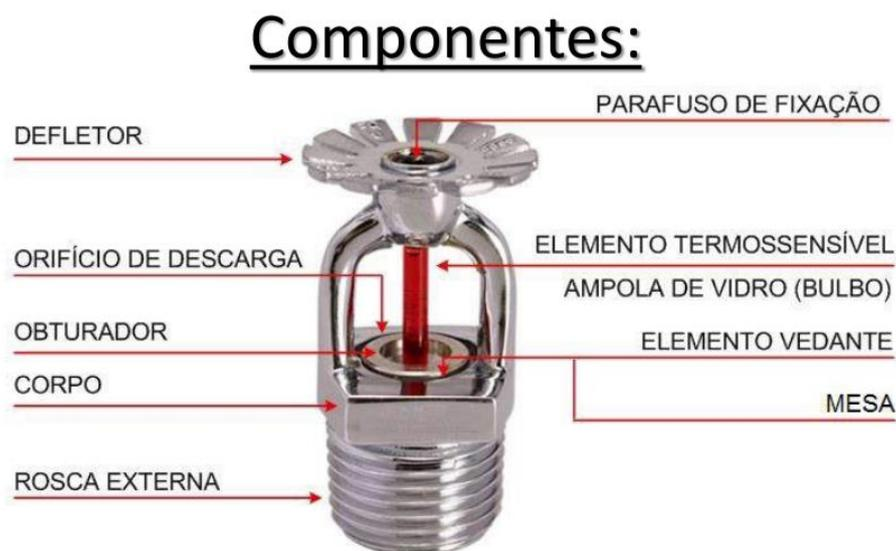
Figura 3.22 Composição de um sprinkler
