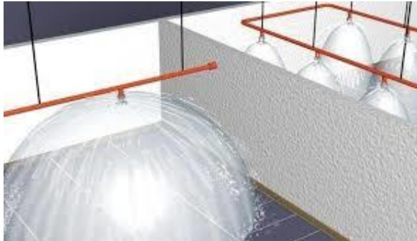
Figura 3.25 Cobertura alargada vs. Cobertura normal (Fonte: <https://www.linkedin.com/pulse/por-que-utilizar-sprinklers-de-cobertura-estendida-santos/>)
