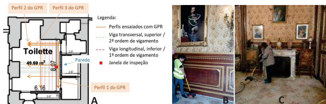
Figura 6 – Toucador da Rainha. A – Representação esquemática dos perfis de georadar, orientação das vigas e localização da janela de inspeção; B - Execução de perfil de georadar paralelamente à parede objeto de estudo; C - Execução de perfil de georadar perpendicularmente à parede
