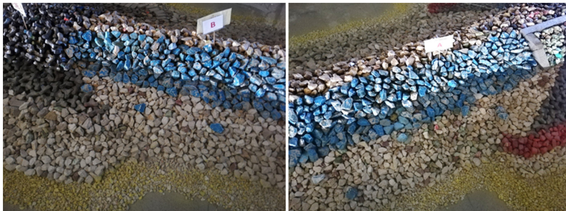
Figura 2 – Solução melhorada. Coroamento e talude interior do quebra-mar destacado. Direção S-10-W. Situação do modelo após a ação de H_s=2.5 m, associado a T_p=17 s e ao nível da maré de +1.6 m (ZH)
