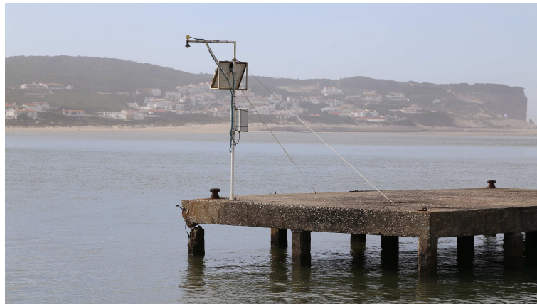
Figura 3.3 – Marégrafo instalado no Cais da Foz do Arelho (janeiro de 2022)
