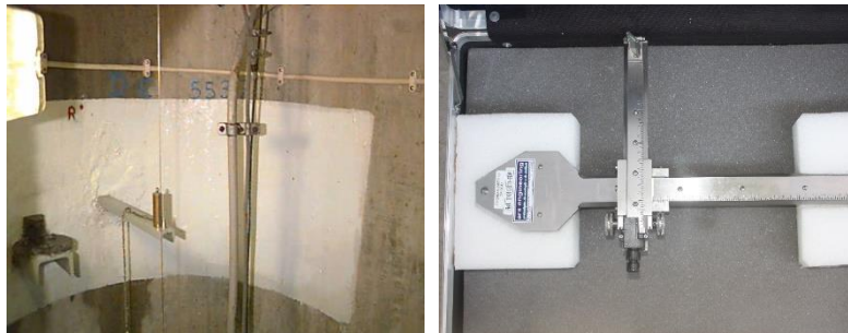
Figura 3.6 – Medição de deslocamentos com fios de prumo: a) base de coordenómetro e respetivo cilindro; e b) coordenómetro ótico
