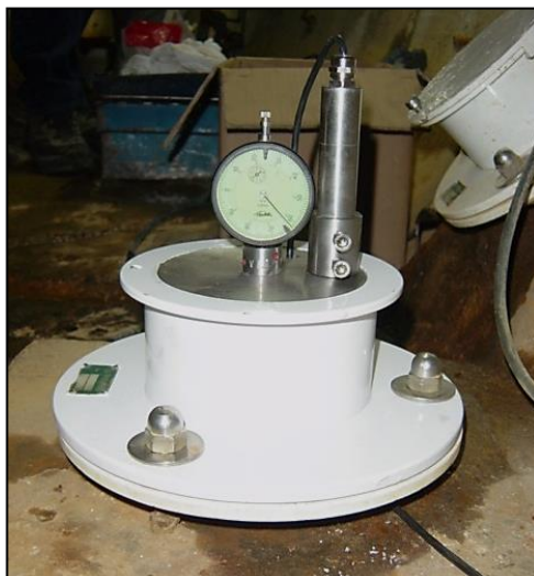
Figura 3.10 – Cabeça de leitura de um extensómetro de varas, onde estão colocados um defletómetro e um dispositivo de recolha automática
