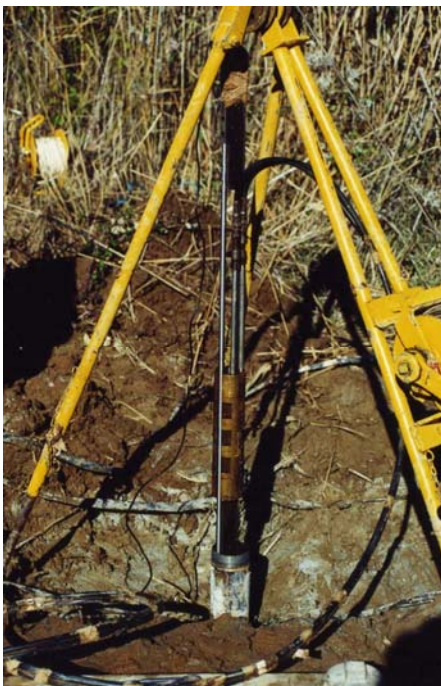
Figura 3.16 – Esquerda - Martelo sísmico da Bison Instruments, Inc. Direita - Geofone triaxial.
