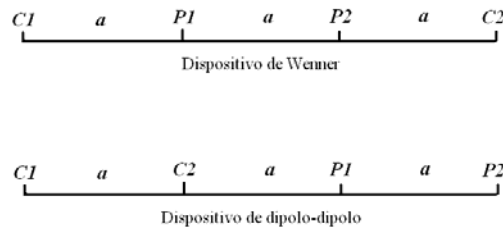
Figura 2.2 – Dispositivos de Wenner e Dipolo-Dipolo.
