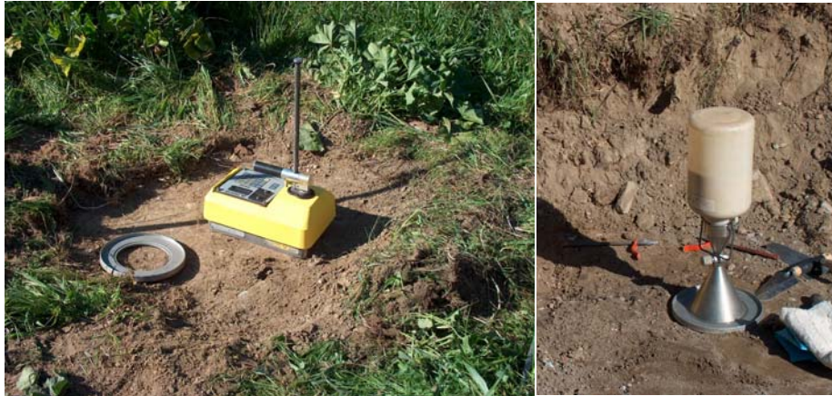
Figura 3.9 - Esquerda - Densímetro – ensaio in situ no início da escavação (profundidades: 0,00, 0,10, 0,20 e 0,30 m). Direita – recolha de amostra pelo método da garrafa de areia (prof. 0,65 m), para ensaio em laboratório.
