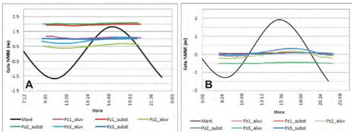
Figura 2 – Casos de estudo de registo de níveis de água em piezómetros duplos
