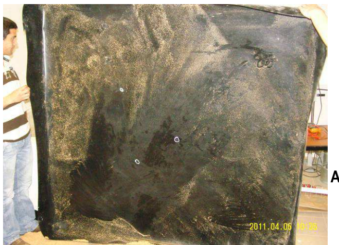
Figure 10 – A - geomembrana com três furos. B - exemplo de um furo com 2 mm
