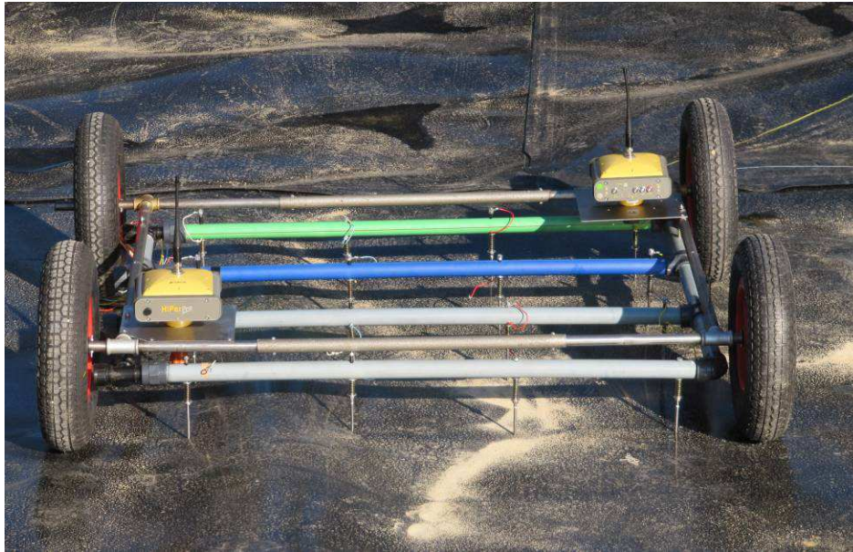
Figura 8 – Módulo de elétrodos com o sistema de georreferenciação geográfica
