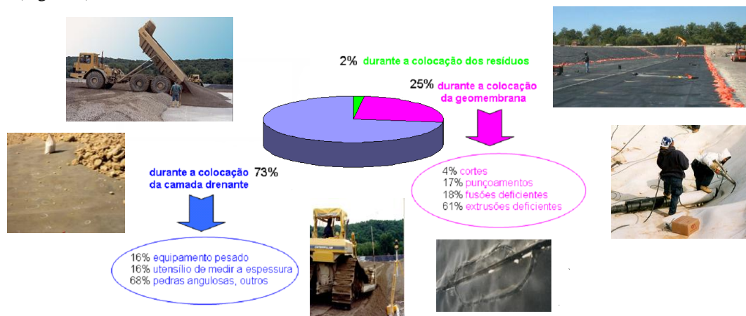
Figura 1 Geomembranas: percentagem e causas dos danos
