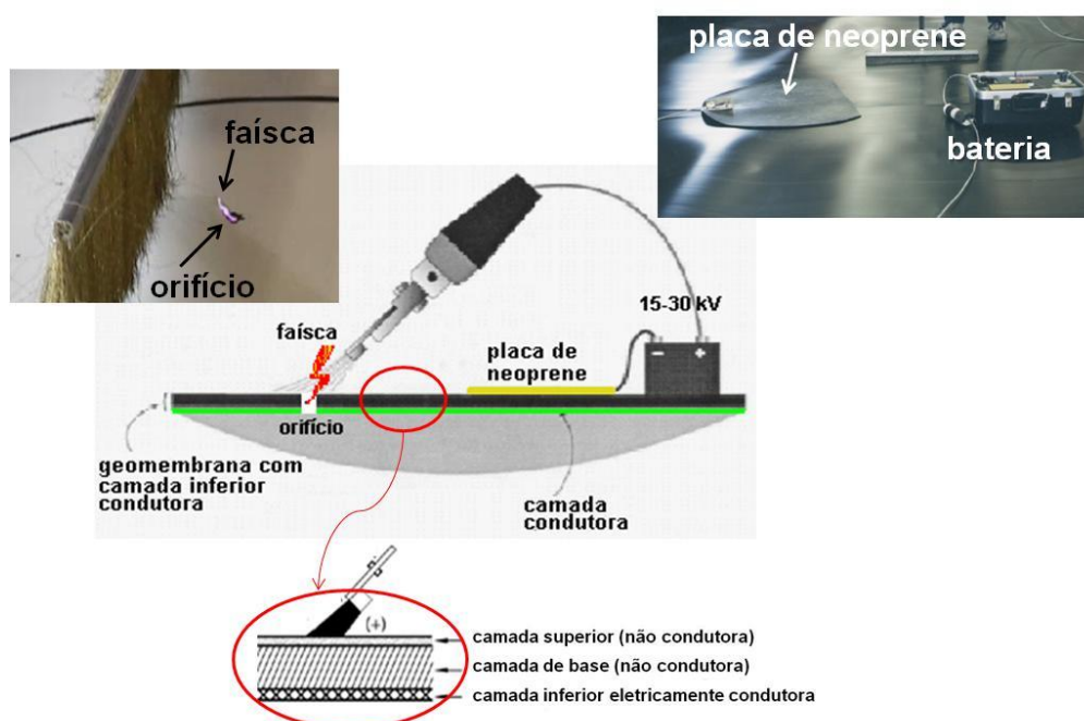
Figura 2 – Esquema do Ensaio da Geomembrana Condutora (adaptado de ASTM D 6747, 2012)
