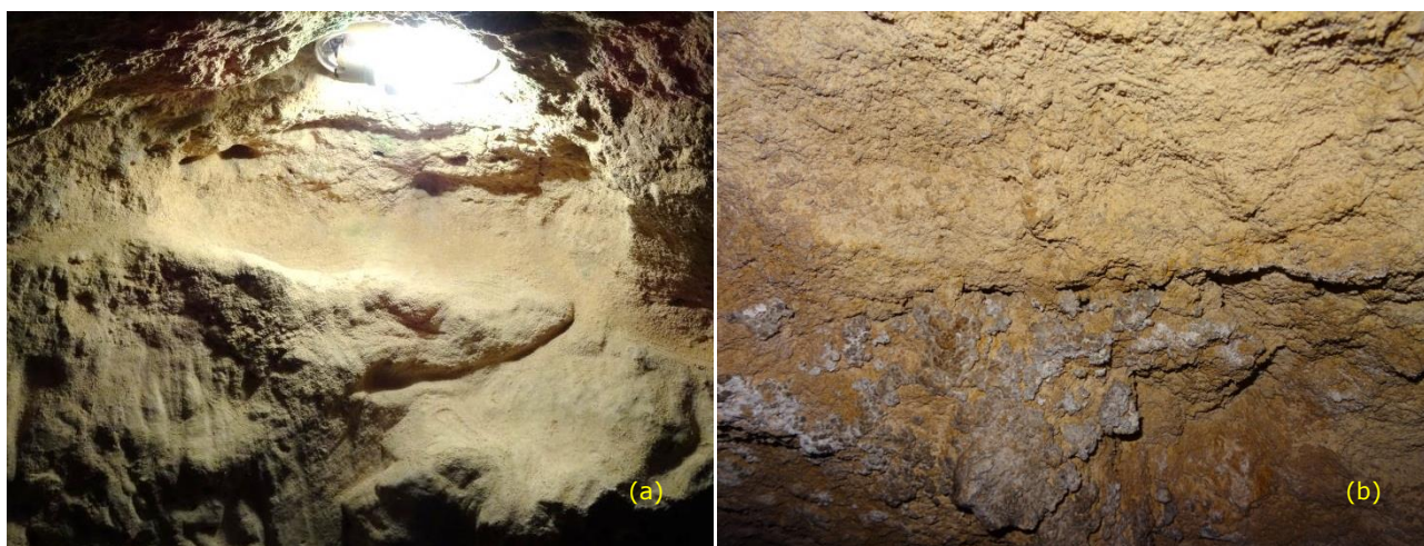
Figura 6 – Principais formações rochosas reconhecidas: (a) com menor grau de cimentação e granularidade mais fina; (b) com maior grau de cimentação e granularidade mais grosseira
