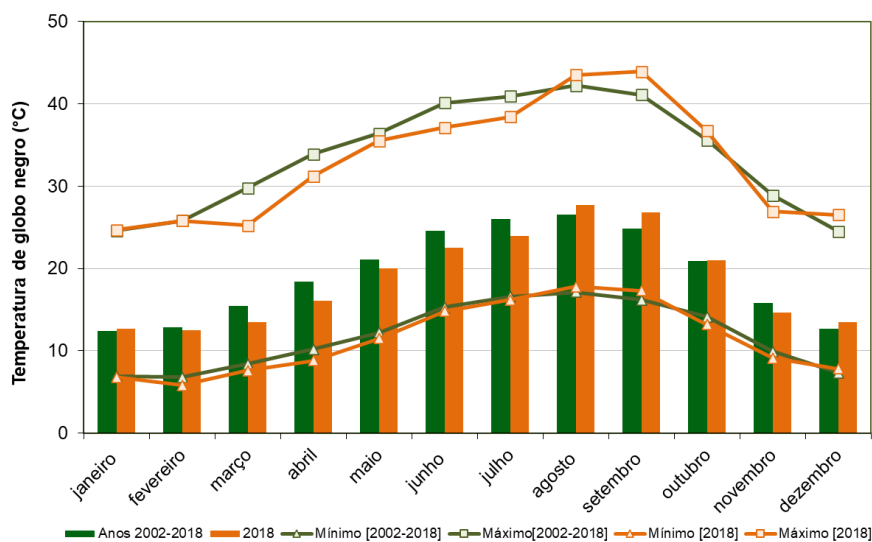
Figura 4.4 – Comparação dos valores da temperatura de globo negro mensais do ano de 2018, com os valores médios dos últimos 16 anos
