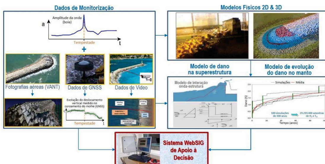
Fig. 1 – Metodologia do projeto: integração de dados de monitorização com resultados de modelação física e numérica.
