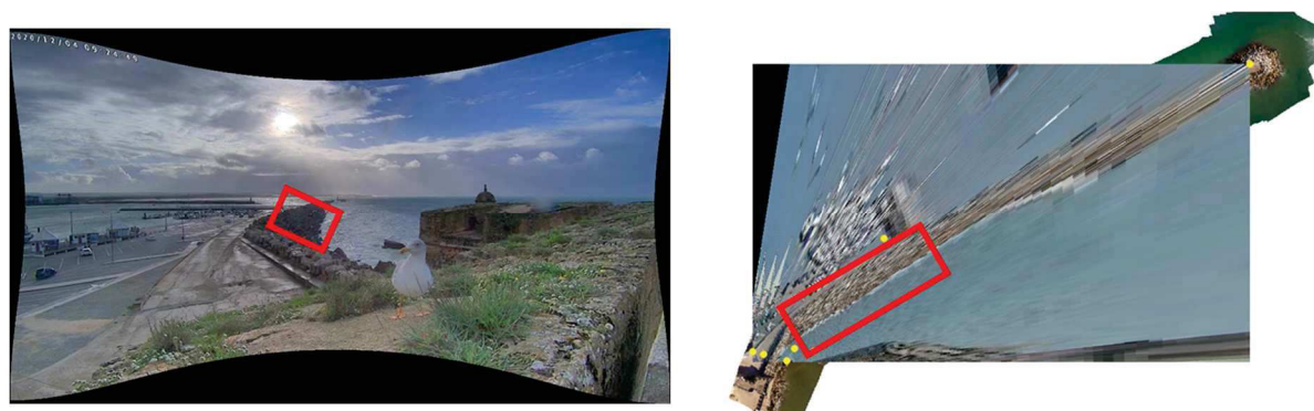
Fig. 8 – Porto de Peniche. Imagens não distorcidas (esq.) e georretificadas (dir.) para estudos hidrodinâmicos quantitativos.
