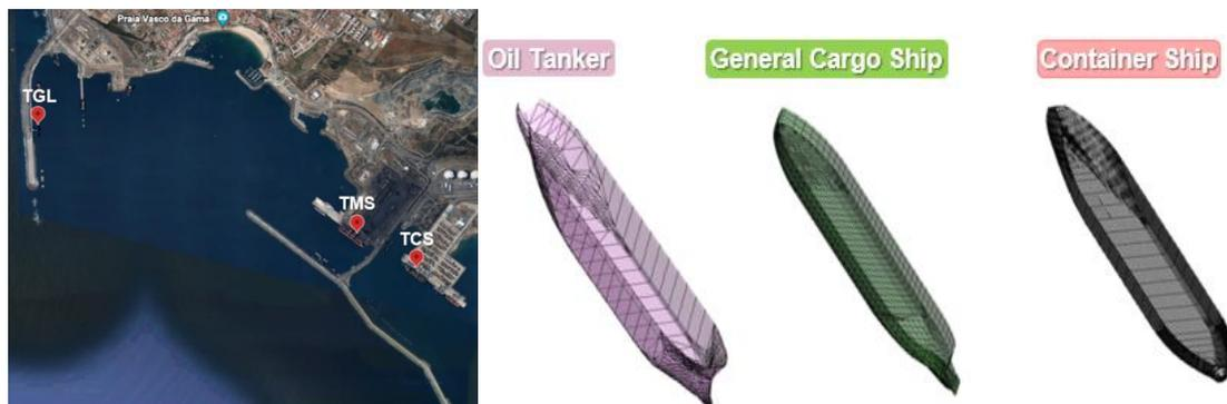
Figura 8. Localização dos terminais TGL, TMS e TCS e respetivos cascos dos navios painelizados.
