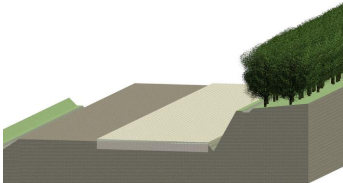
Aplicação da sub-base
