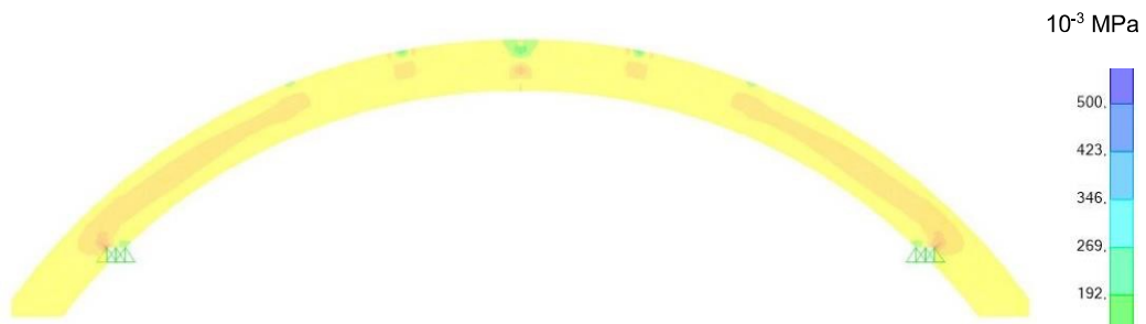
Figura 7. S22: Tensões perpendiculares às fibras – apoios fixos
