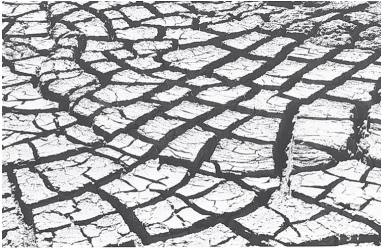
Figura 1-4 – Padrão superficial de fendilhação e fissuração de retração num terreno de granulometria fina [Blight, 2013]
