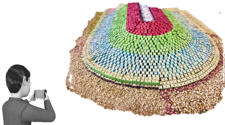
Figura 6. Captura de imagens à volta do modelo para as técnicas Metashape e LiDAR
