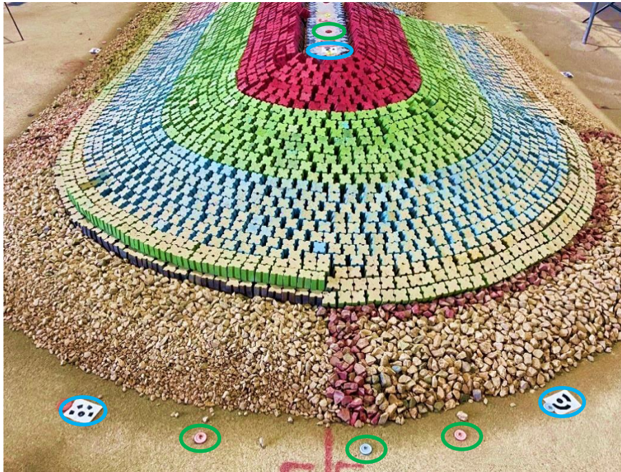
Figura 5. Pontos de controlo usados para georreferenciar as nuvens de pontos (a verde) e marcadores de referência visual (a azul)
