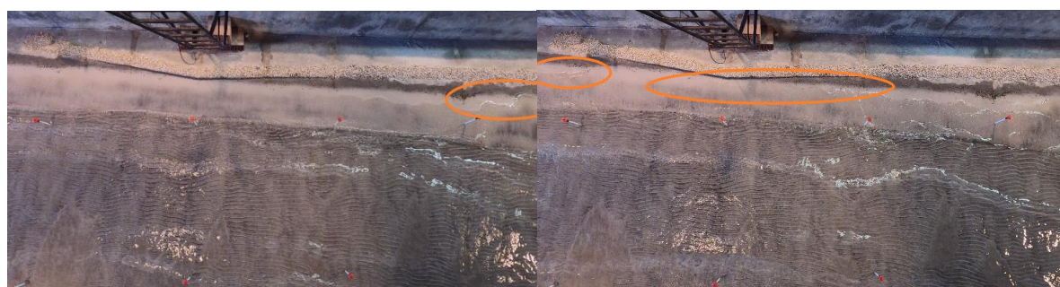
Figura 5.2 – Ensaio sem QMD. Agitação irregular: T_p=14 s; H_s= 4,0 m. Aspeto do espraiamento junto à estrutura de defesa longitudinal aderente
