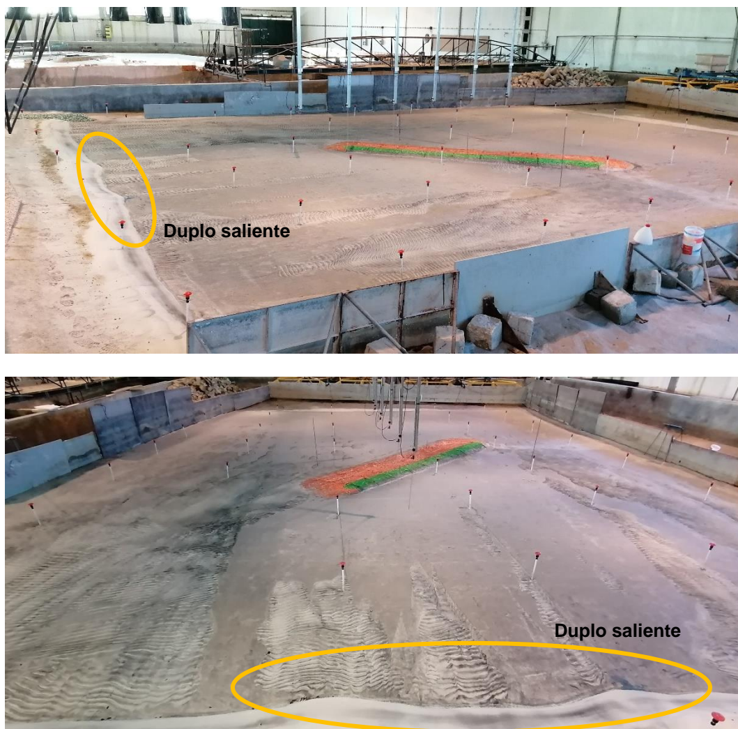
Figura 3.5 – Imagens dos salientes após a execução da série C
