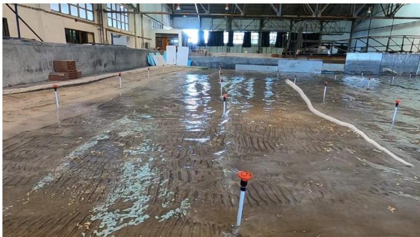
Figura 4.14 – Ensaios sem QMD, com QMD 45° e QMD 0°. Agitação regular: T=12 s; H=3,0 m. Linha de rebentação
