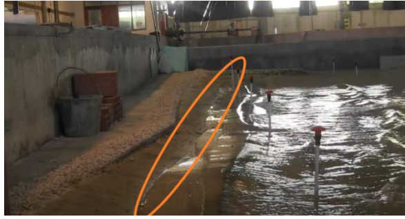
Figura 5.5 – Ensaio com QMD 45°. Agitação irregular: T_p=12 s; H_s= 5,0 m. Aspeto do espraio junto à estrutura de defesa longitudinal aderente
