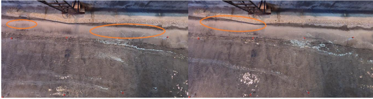
Figura 5.3 – Ensaio sem QMD. Agitação irregular: T_p=16 s; H_s= 3,0 m. Aspeto do espraio junto à estrutura de defesa longitudinal aderente
