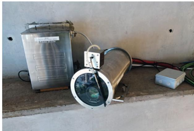
Figura 12 Sistema de monitorização por correlação digital de imagem, montado sobre o pilar P17.4
