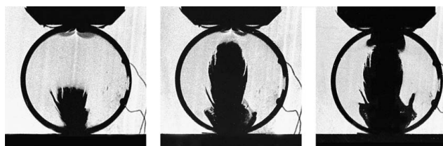
Figura 5- Quebra de discos de vidro para uma carga de 46 kN (Schönert, 2004)
