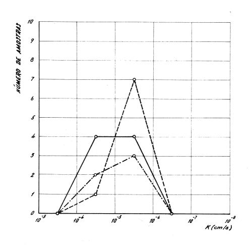
FIG. 3 \_ SOLOS XISTOSOS - MEDIÇÃO DO COEFICIENTE DE PERMEABILIDADE EM AMOSTRAS INTACTAS. POSSÍVEL INFLUÊNCIA DA PRESSÃO DE CONFINAMENTO NO VALOR DE GRANDEZA A MEDIR
