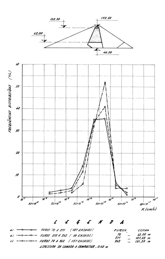
FIG.1\_SOLOS ARGILOSOS\_NÚCLEO CENTRAL\_ENSAIOS DE CAMPO.ANÁLISE ESTATÍSTICA DOS RESULTADOS OBTIDOS PARA O VALOR DE K
