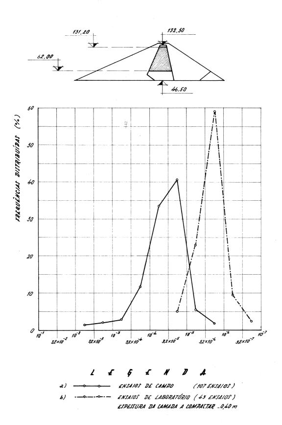
FIG. 5 - SOLOS ARGILOSOS -NÚCLEO CENTRAL . ANÁLISE ESTATÍSTICA COMPA RATIVA DOS RESULTADOS OBTIDOS PARA O VALOR DE K EM EN SAIOS DE CAMPO E EM ENSAIOS DE LABORATÓRIO
