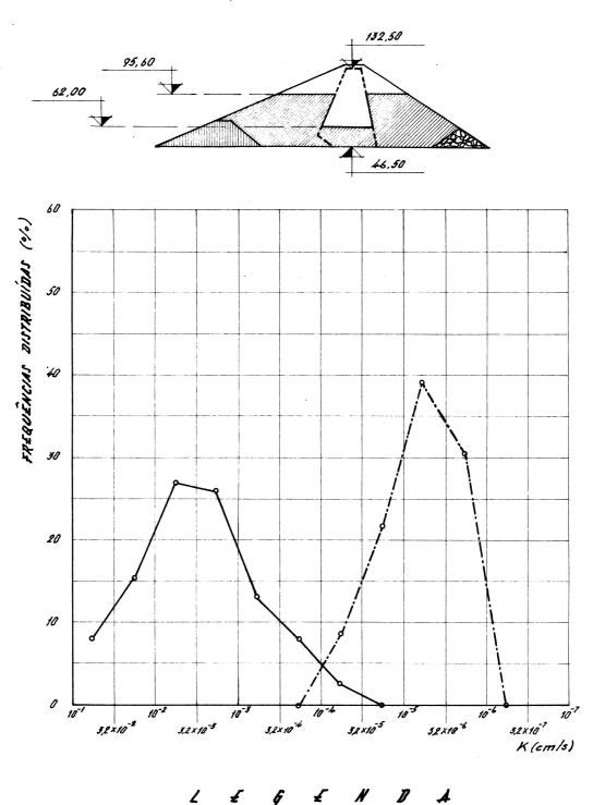
FIG. 2 - SOLOS XISTOSOS. ANÁLISE ESTATÍSTICA COMPARATIVA DOS RESULTADOS OBTIDOS PARA O VALOR DE K EM ENSAIOS DE CAMPO E EM ENSAIOS DE LABORATÓRIO
