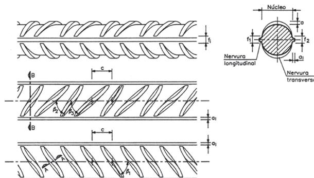
Figura 1 – Disposição das nervuras transversais e longitudinais num varão MEGASA 500S – SEIXAL
