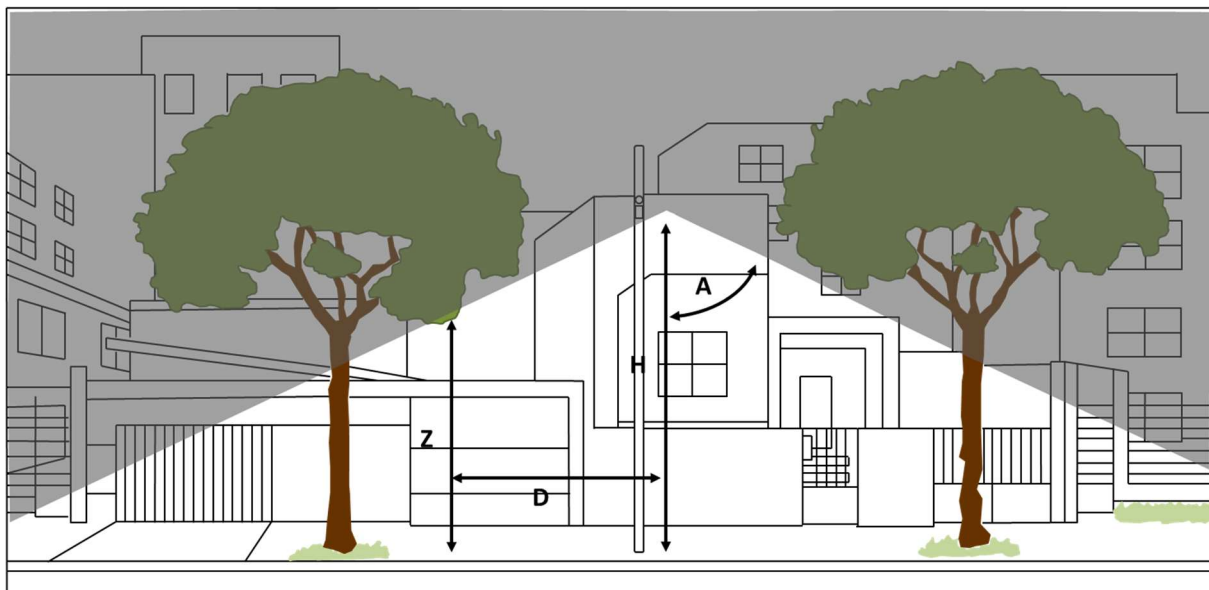
Figura 4.120 – Cálculo para desobstrução da iluminação relativamente a árvores no sentido longitudinal da via (Perfeitura de São Paulo, 2015)
