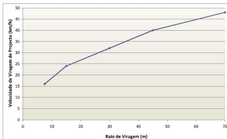
Figura 4.43 – Relação entre o raio e a velocidade de viragem (Silva e Santos, 2011)
