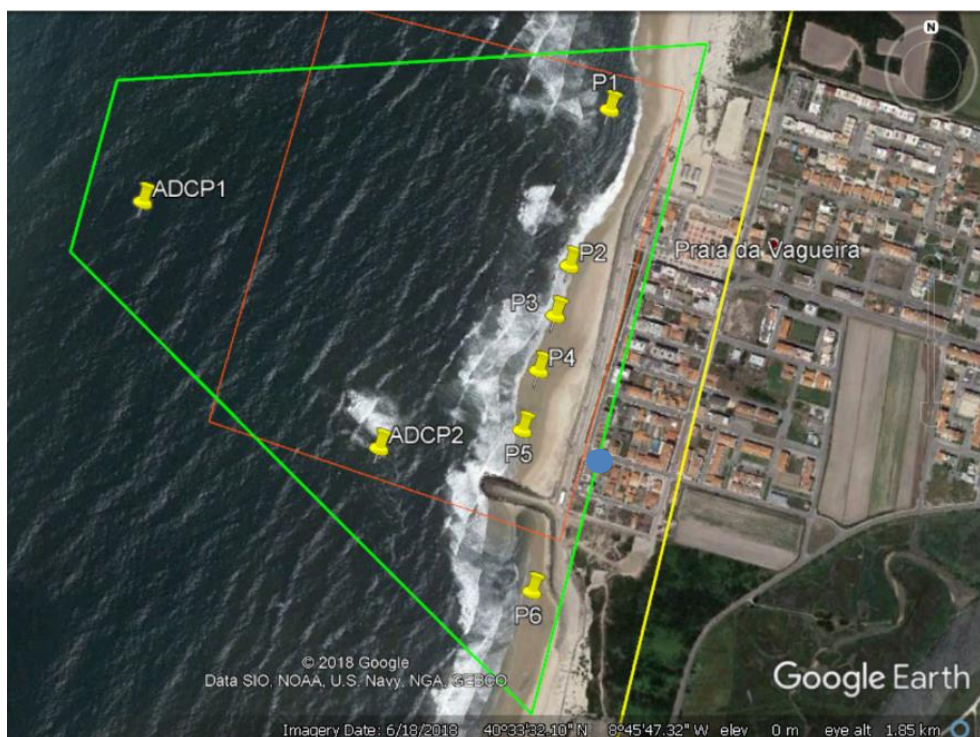
Figura 2.8 – Localização dos pontos onde foram colocadas estruturas de suporte dos instrumentos de medição e do sistema de vídeo-monitorização (ponto azul) (fonte: Silva et al. , 2020)
