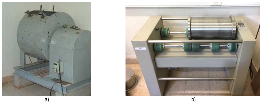
Figura 3.2 – Aspeto dos equipamentos de ensaio: a) Los Angeles; b) micro-Deval
