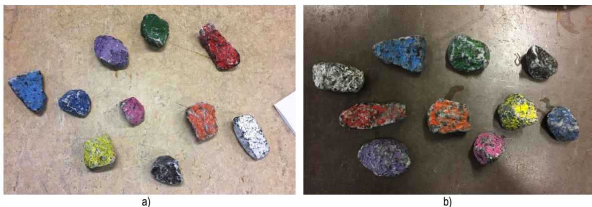
Figura 3.15 – Aspeto de algumas partículas: a) após 2000 revoluções; b) após 14 000 revoluções (b) (Afonso; 2019)
