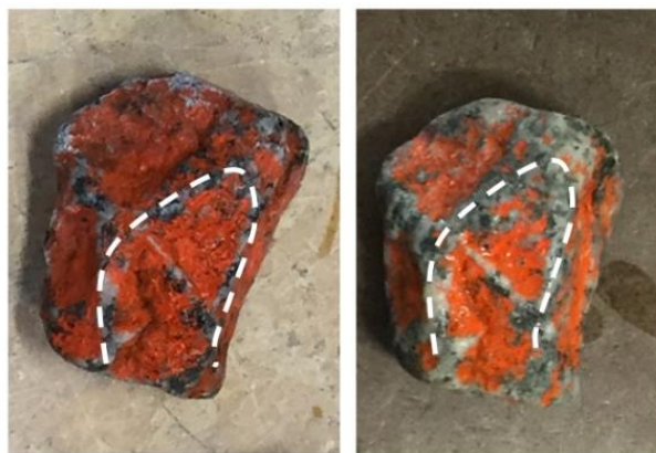
Figura 3.19 – Aspetos da partícula 1 após 2000 e 14 000 revoluções
