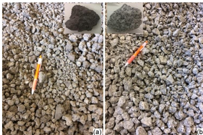
Figura 9.1 – Aspeto dos materiais estudados: a) ASIC; b) agregado de granito (Delgado; et al. ; 2019c)
