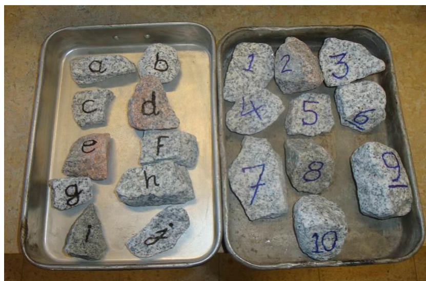
Figura 3.3 – Partículas de balastro granítico utilizadas no estudo (Jerónimo; 2014)
