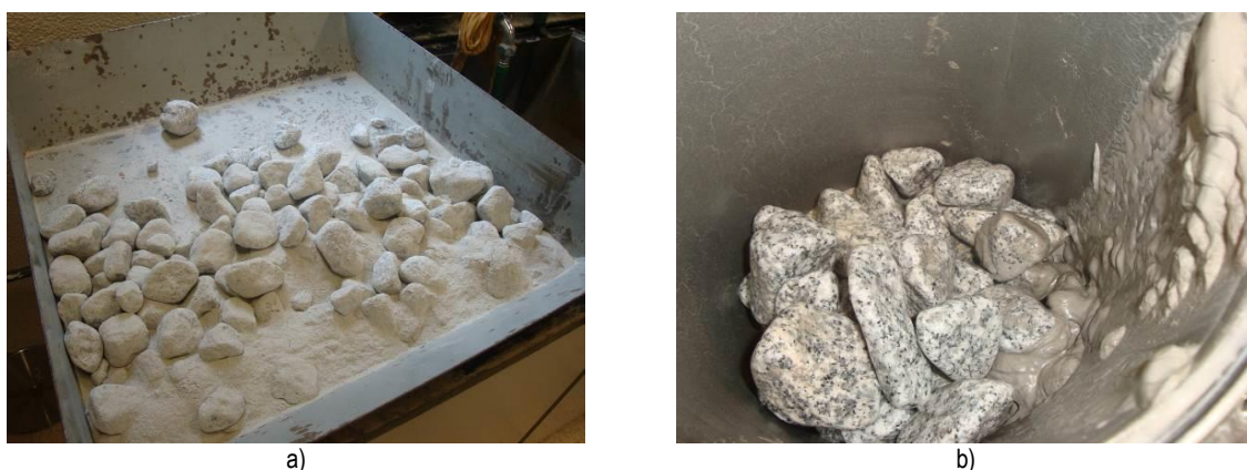
Figura 3.8 – Amostras de balastro no final dos ensaios: a) Los Angeles; b) micro-Deval (Jerónimo; et al. ; 2020)
