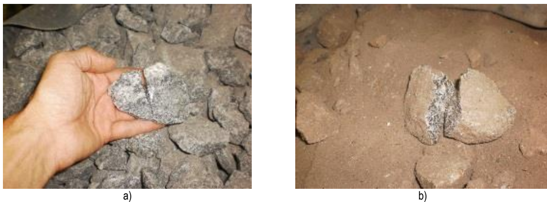
Figura 8.5 – Degradação das partículas avaliada após os ensaios de deformação permanente: a) balastro limpo; b) balastro contaminado (Costa; et al. ; 2017)
