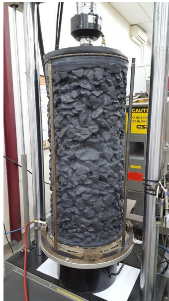
Figura 8.2 – Aspeto de um provete de balastro pronto para ensaio (Costa; et al. ; 2017)
