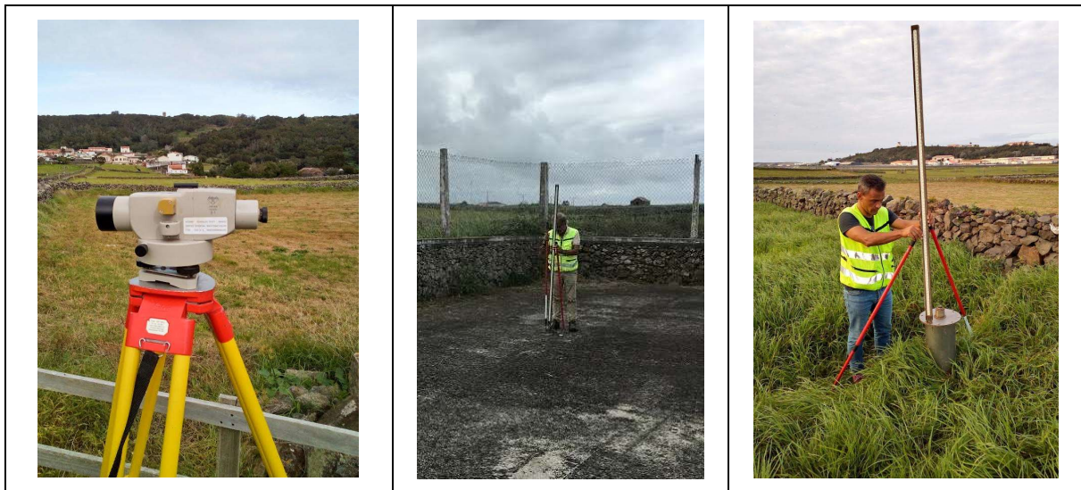
Figura 2.9 – Aspeto do nível Sokkisha, à esquerda, do nivelamento do furo FP4, ao centro, e do nivelamento do furo FB7, à direita
