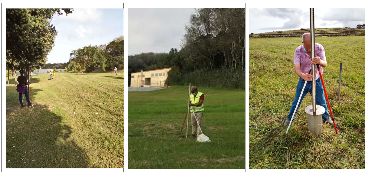
Figura 2.12 – Aspeto do nivelamento do furo MW29, à esquerda, do furo MW22, ao centro, e do furo FB3, à direita
