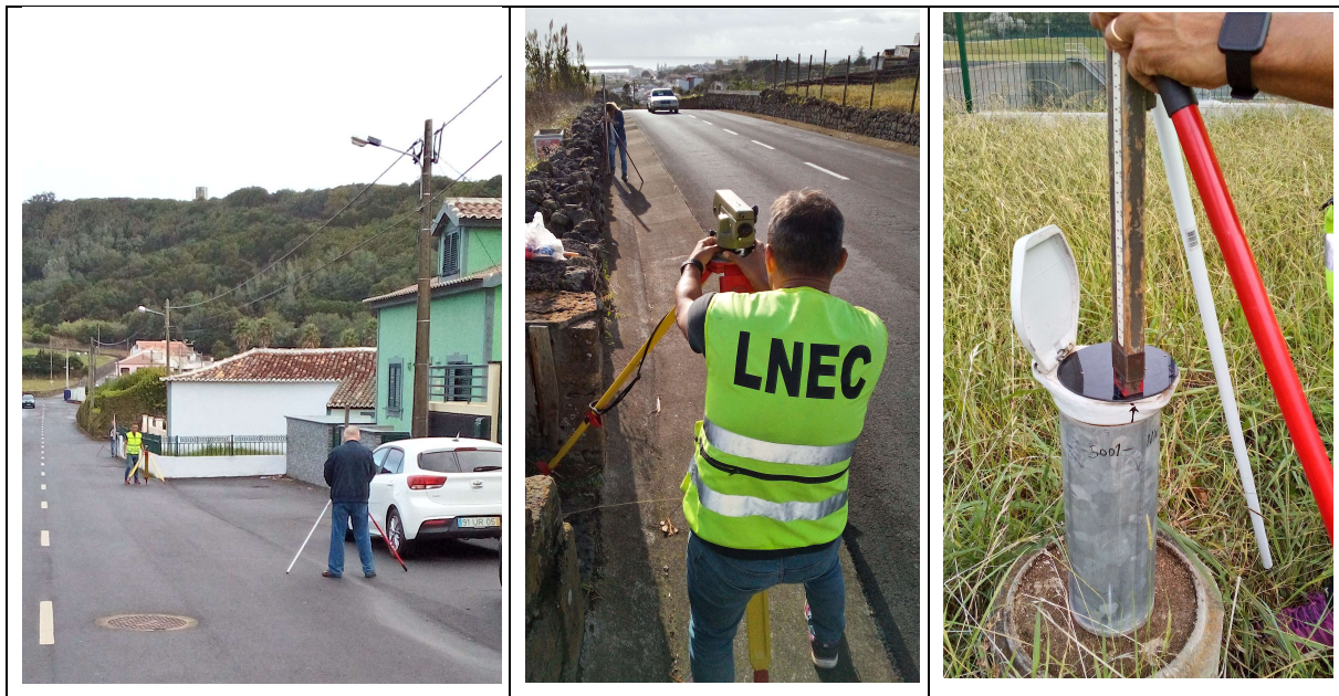
Figura 2.8 – Aspeto do nivelamento dos pontos de passagem de acesso ao furo MW 25, à esquerda e ao centro, e nivelamento da boca do furo MW25, à direita
