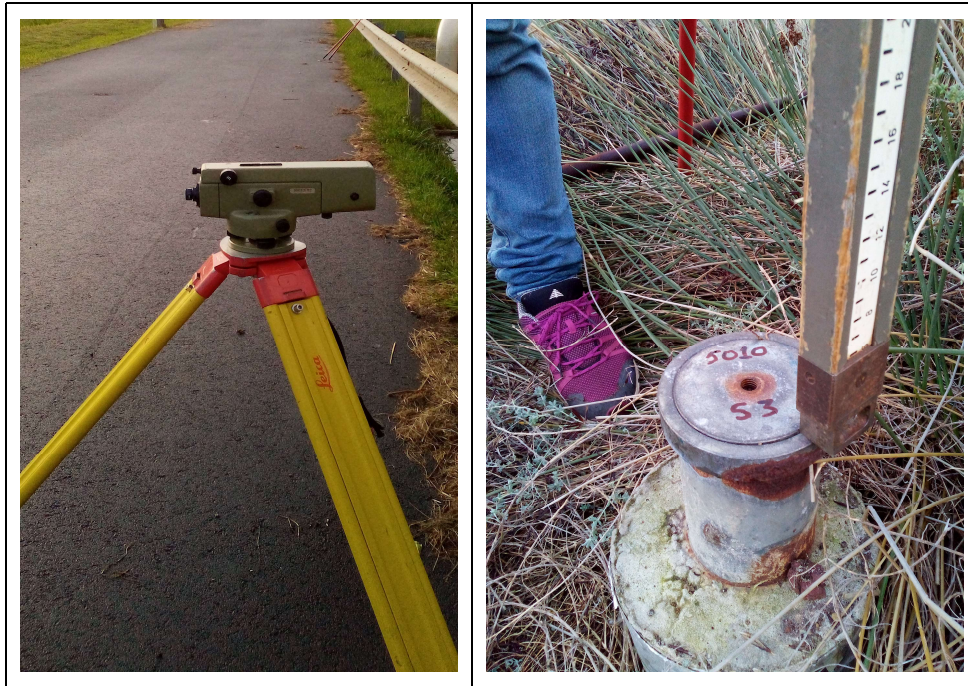
Figura 2.1 – Nível NA2, à esquerda, e mira com escala de invar no ponto de partida, à direita
