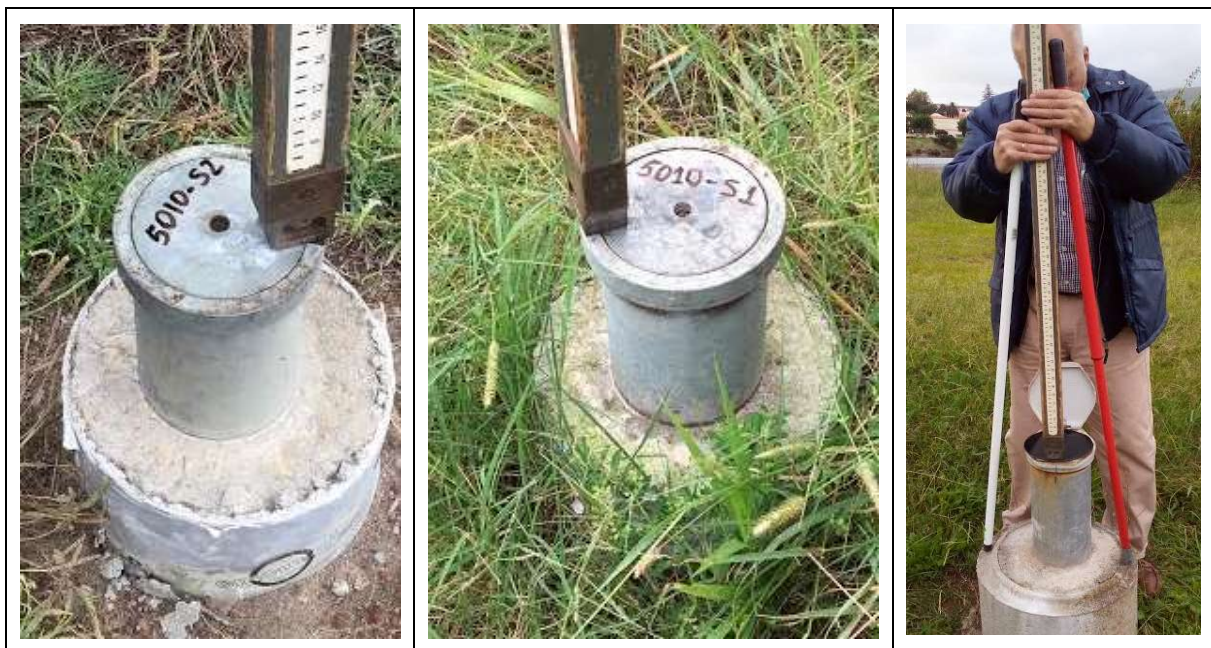
Figura 2.2 – Aspeto do nivelamento dos pontos S2, S1 e MW24
