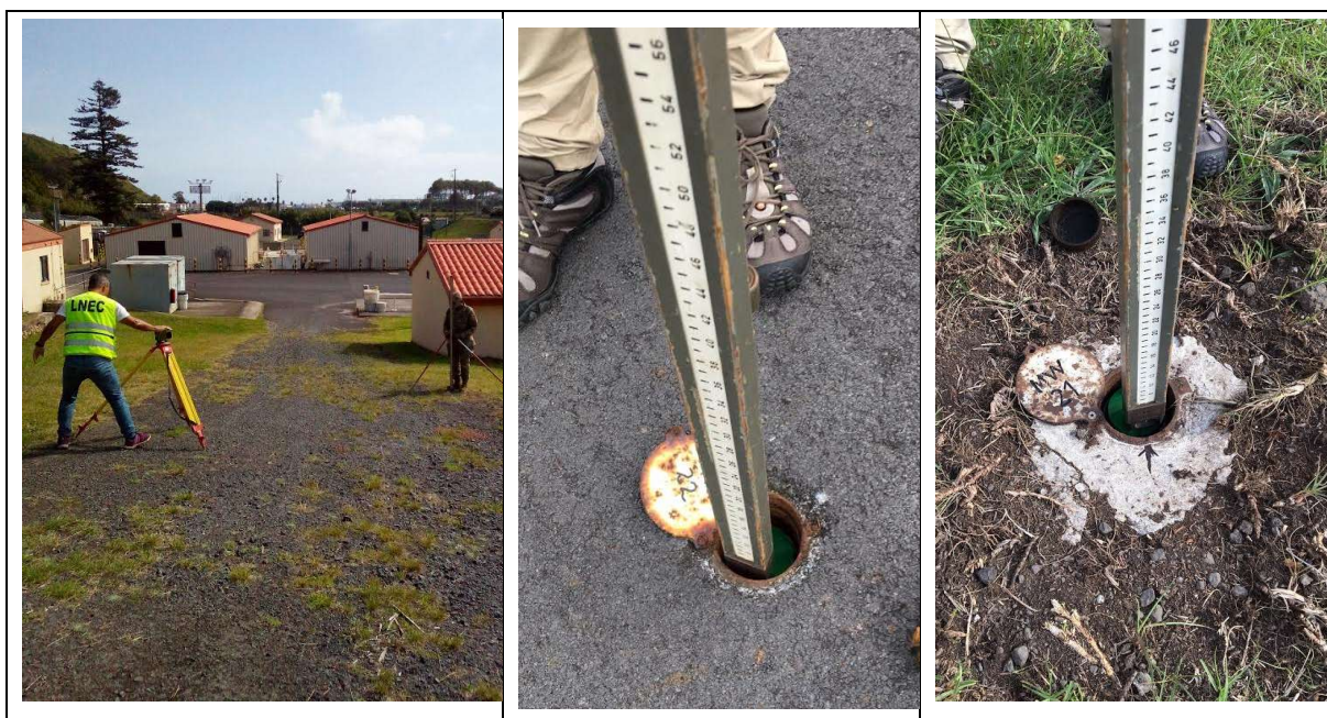
Figura 2.6 – Aspeto da ligação ao furo MW18, à esquerda, do nivelamento do furo MW22, ao centro, e do nivelamento do furo MW21, à direita
