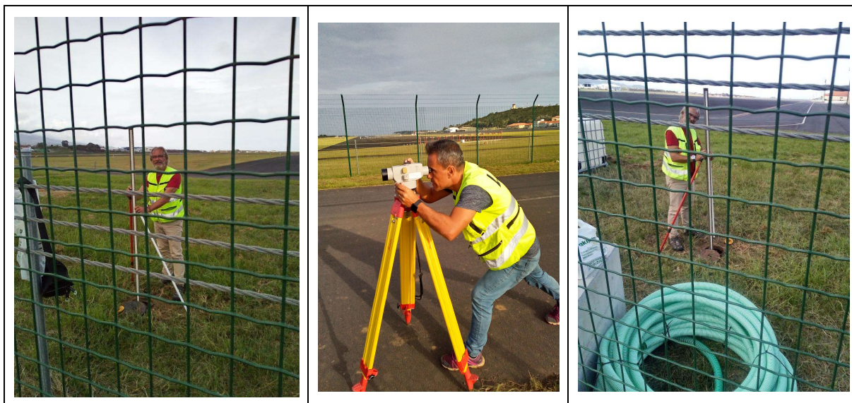
Figura 2.11 – Aspeto do nivelamento do furo MW31, à esquerda, da ligação entre o furo MW31 e o furo MW30, ao centro, e do nivelamento do furo MW30, à direita
