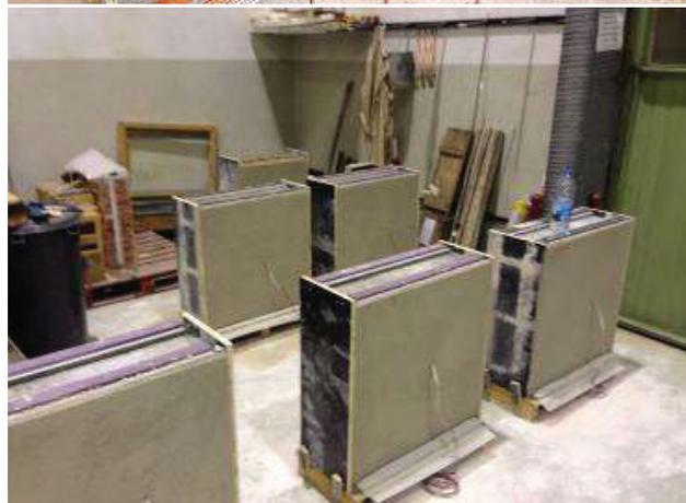
Figura 14 Aplicação dos revestimentos armados nos novos muretes
