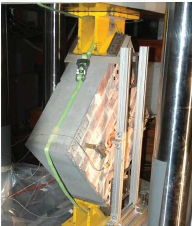
Figura 12 Murete novo durante o ensaio
