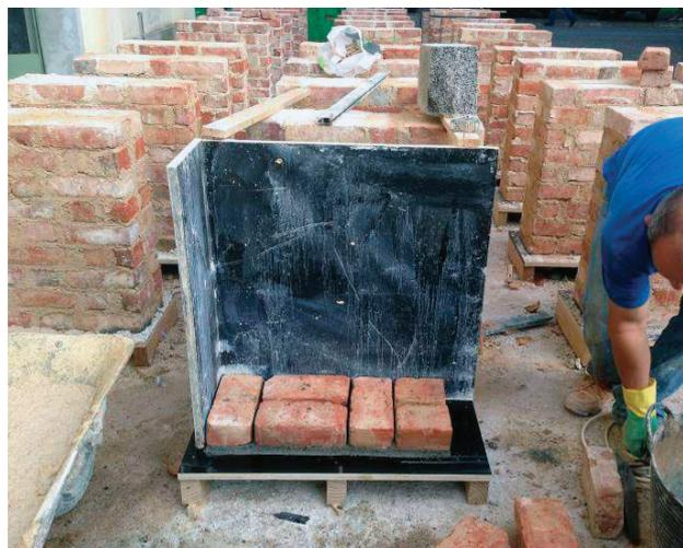
Figura 11 Construção de *muretes* novos de tijolo cerâmico maciço
