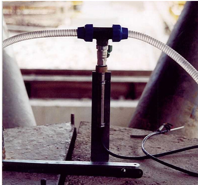
Figura 2 – Utilização de uma célula de pressão para através de um sistema de níveis líquidos proceder à medição de deslocamentos verticais
