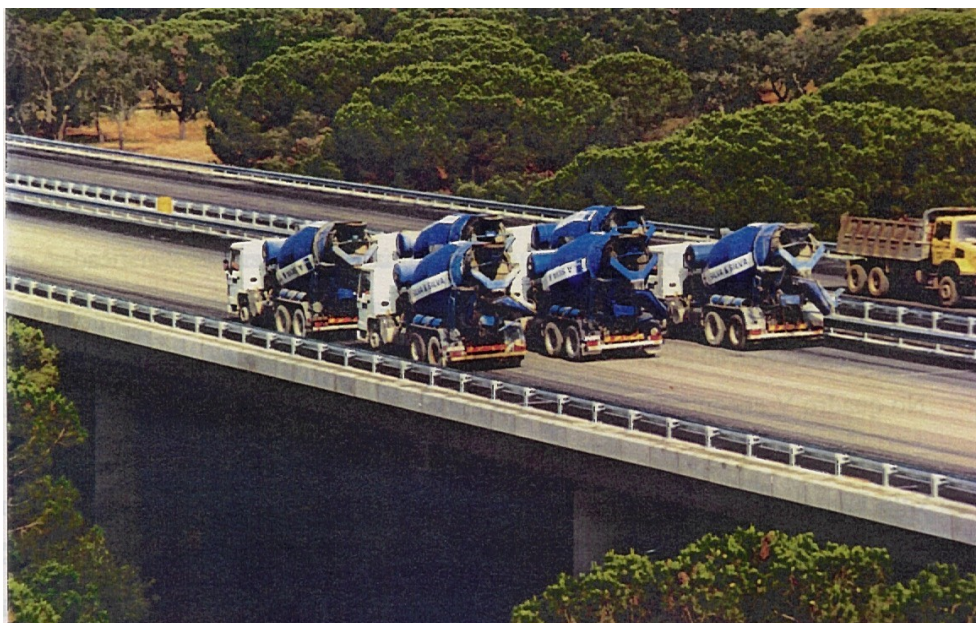
Figura 12 – Ensaio de carga em estruturas de dimensão corrente
