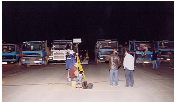
Figura 8 – A utilização de um nível de precisão durante o ensaio de carga do aeroporto da Madeira
