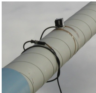
Figura 14 – Acelerómetro para a medição da força num tirante através do método da vibração
