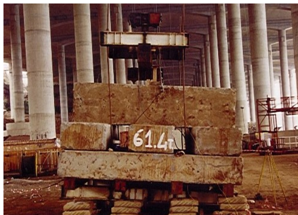
Figura 17 – Ensaio impulsivo no Aeroporto da Madeira: libertação de uma massa de 61 400 kg
