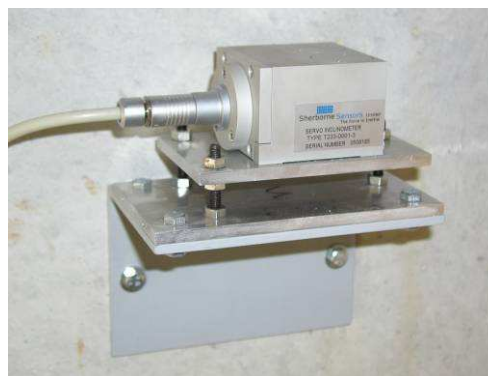
Figura 7: Pormenor de um clinómetro eléctrico
