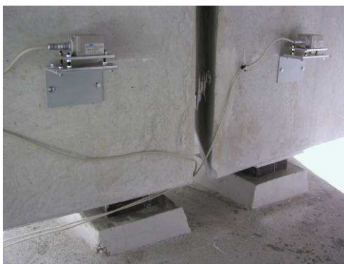
Figura 6: Medição de rotações sobre um apoio intermédio
