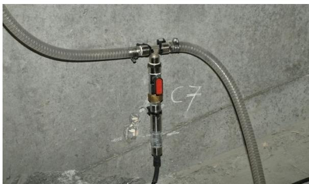
**Figura 8 – Célula de pressão de um sistema de nivelamento hidrostático**
