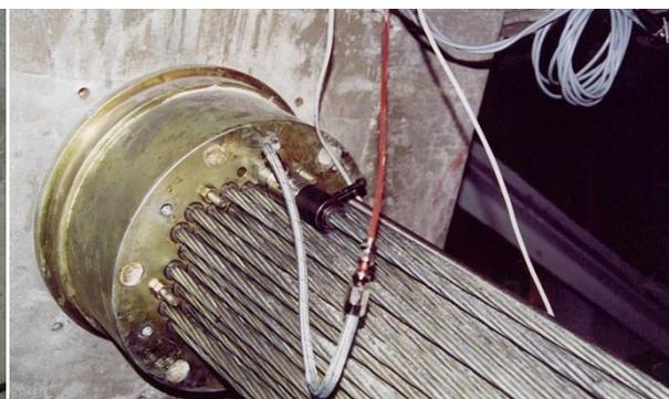
**Figura 9 – Célula monocordão para a medição das forças nos estais**
