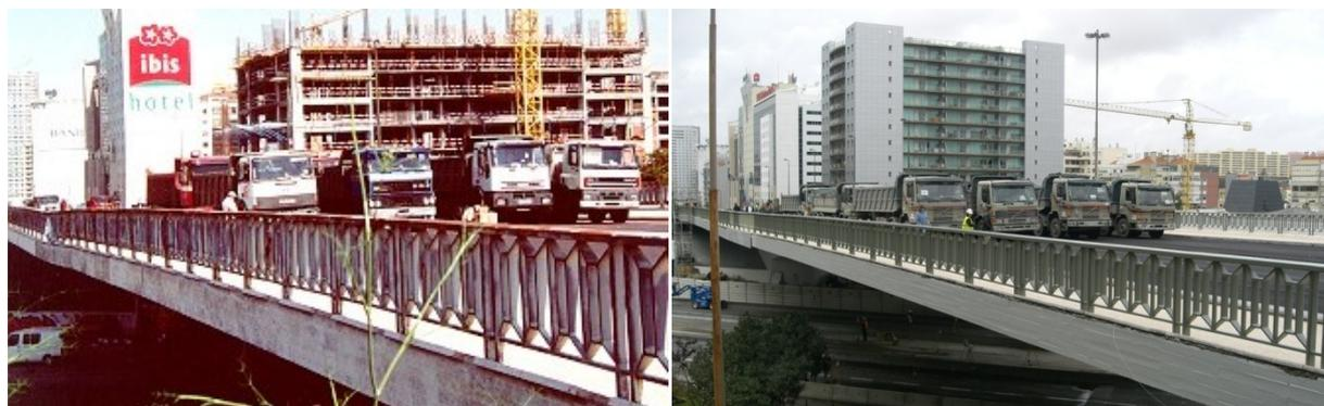
**Figura 12 - Ensaios de carga antes e após a reabilitação**
