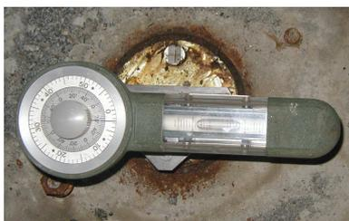
Figura 10 – Medição de rotações com clinómetro mecânico
