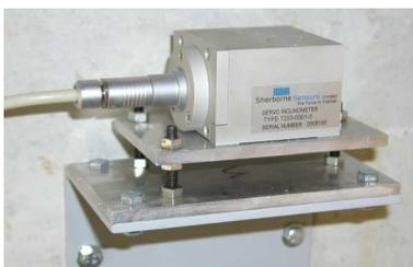
Figura 11 – Medição de rotações com clinómetro eléctrico
