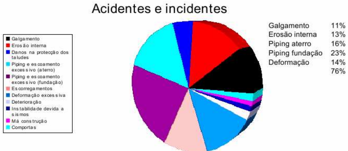
Figura 5 – Estatísticas de acidentes em barragens de aterro (adaptado de Fell, et al. 1992)
