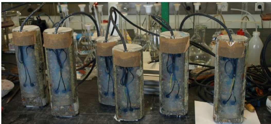
Fig. 5 – Carotes instrumentadas em laboratório com os sensores de resistividade
