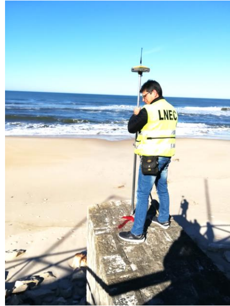
Figura 2.14 – Praia de São Pedro de Moel: coordenação de um ponto assinalado com tinta pela equipa do NGA
