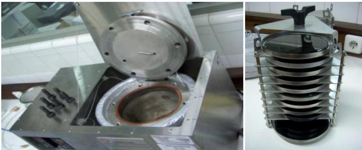
**Fig.2. PAV (esq.) e recipientes com material para envelhecimento (dir.)**
