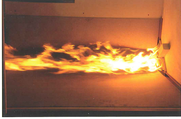
↑ ← Ensaios «Single Burning Item» (SBI) de produtos e sistemas de construção e ensaio de pisos/pavimentos na Unidade de Reação ao Fogo (URF) do LNEC.
