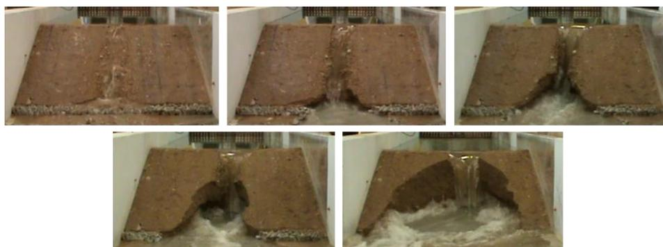
Fig. 2. Evolução da brecha no Ensaio 1.
