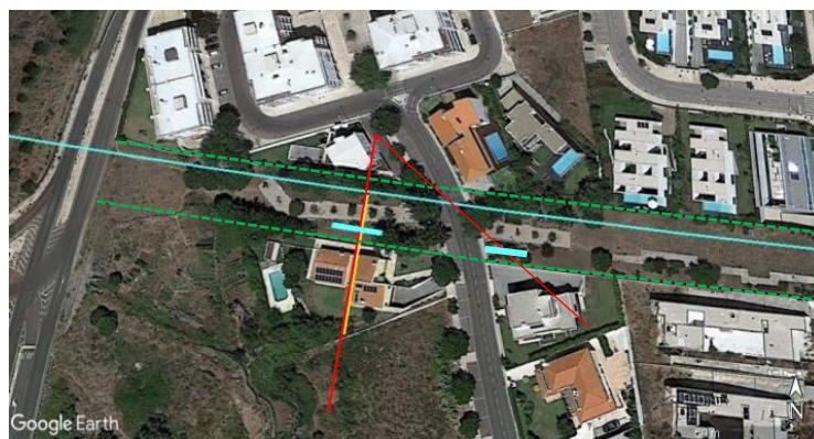
Figura 11 – Enquadramento, sobre imagem do Google Earth, da faixa de proteção do aqueduto (linha a traço interrompido de cor verde), linha de união entre as últimas claraboias visíveis a Oeste e a Este da urbanização (linha azul), perfis de resistividade elétrica (linhas de cor vermelha e amarela) e posição do aqueduto interpretada com base nos resultados dos modelos de resistividade elétrica obtidos (traços de cor azul clara)
