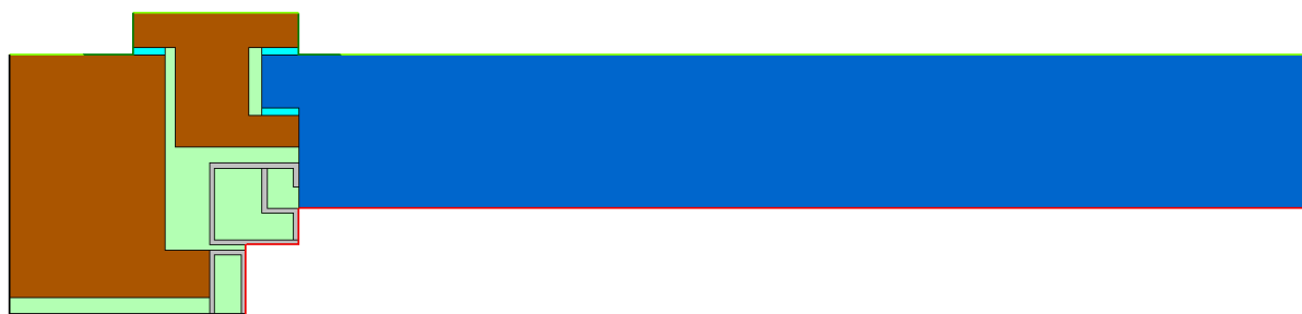
Figura 2.2 – Caso de validação n.º 2: Janela mista madeira-alumínio
