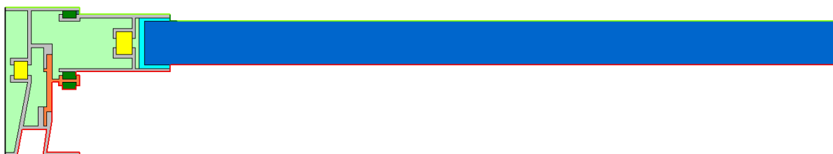
Figura 2.7 – Caso de validação n.º 6.2: Janela de correr conforme desenho da norma EN ISO 10077-2: 2012
