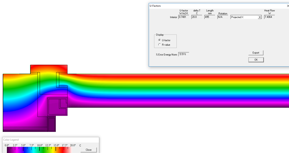
Figura 3.2 – Caso de validação n.º 2 – Perfil misto madeira-alumínio
