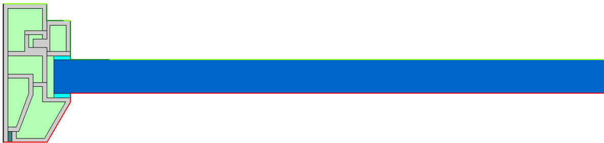
Figura 2.8 – Caso de validação n.º 7: Janela com folha fixa
