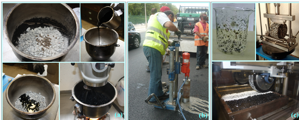
Fig.1. a) Fabrico de SMA em laboratório (mistura a quente de agregados, fibras e betume); b) Recolha de carotes em obra para caracterização em laboratório; c) Ensaios de avaliação do desempenho: suscetibilidade ao escorrimento (método de Schellenberg ), sensibilidade à água em ensaios de tração indireta; resistência à deformação permanente em ensaios de simulação em pista de laboratório.
